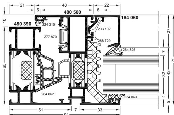
AWS 65 HI<sup>+</sup> coniuga la profondità costruttiva di soli 65mm con elevatissime prestazioni termiche ed impressionanti proprietà in termini di: funzionalità, design e semplicità costruttiva.
