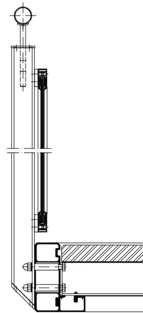
Befestigung an der Stahlbetondecke
