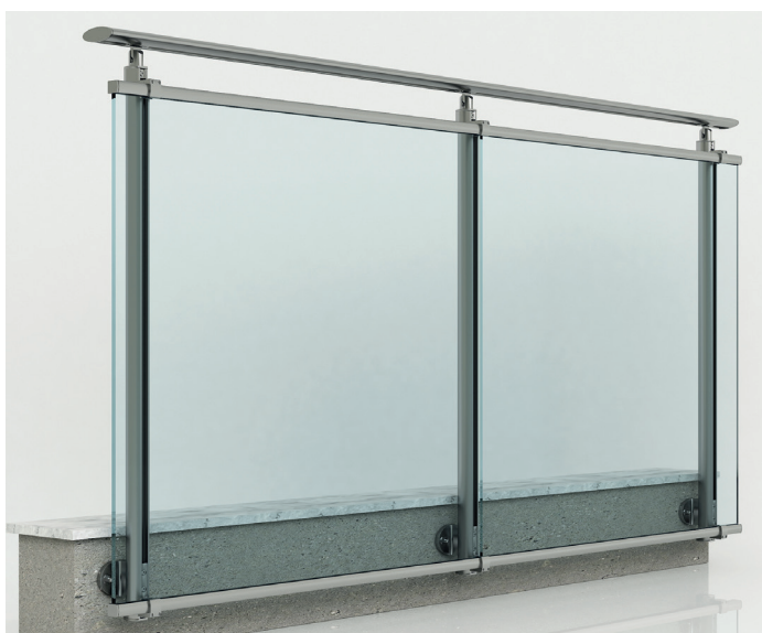
Variante con guida continua; fissaggio fronte solaio
