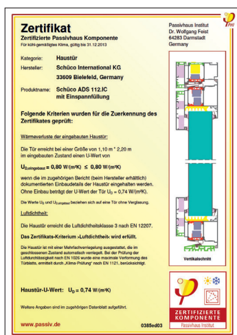
Schüco ADS 112 IC: con certificato casa passiva Schüco ADS 112 IC: passive house certified
