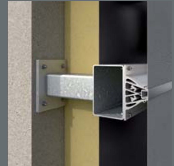
FACID 65 als vorgehängte hinterlüftete Fassade (VHF) auf tragender Wand mit durchgehender Stahlkonstruktion, Dämmung und diffusionsoffener Fassadenmembran. FACID 65 as rear-ventilated facade on load-bearing wall with continuous steel tube, insulation and diffusion-open facade membrane.
