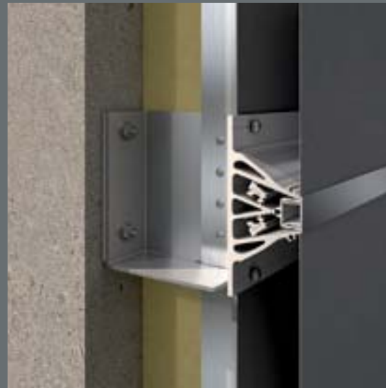
FACID 65 als vorgehängte hinterlüftete Fassade (VHF) auf tragender Wand mit Konsolen, Dämmung und diffusionsoffener Fassadenmembran. FACID 65 as rear-ventilated facade on load-bearing wall with brackets, insulation and diffusion-open facade membrane.
